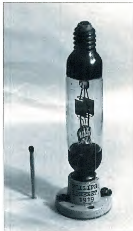
Figuur 2: Radiolamp met cilindervormige anode
